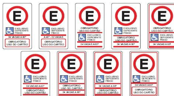
SINALIZAÇÃO VERTICAL VAGA PCD
